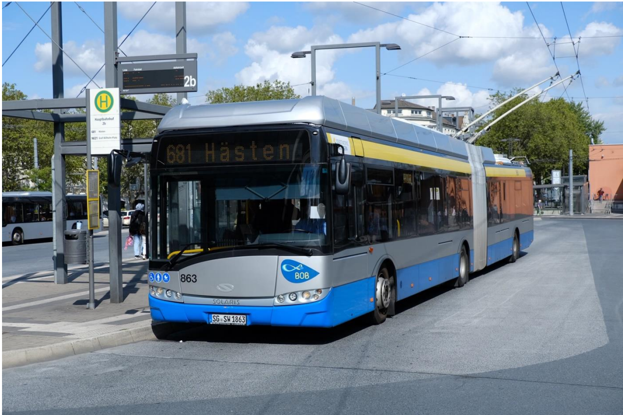
Abbildung 2: Batterieoberleitungsbus (BOB) vom Hersteller Solaris im Betrieb der Solinger Stadtwerke Foto: Böhm.
